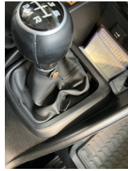
Şanzıman, Vites körüğü > Hasarlı
