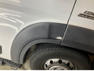
Kapı, sağ ön, Kapı bandı > Hasarlı
