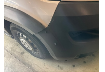
Çamurluk, sağ, Çamurluk, sağ > Sökülmüş-Yok
