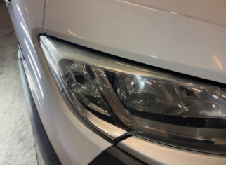
Farlar, Far camı, sağ > Deforme Olmuş
