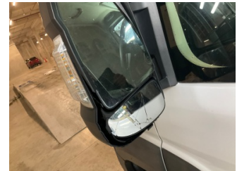
Dikiz aynası, sol, Ayna camı > Hasarlı
