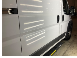
Kapı, sağ arka, Kapı, sağ arka > Ezik
