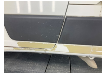
Marşbiyel, sol, Marşbiyel, sol > Boyası Atmış
