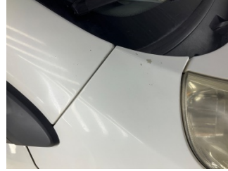
Çamurluk, sağ, Çamurluk, sağ > Boyası Atmış
