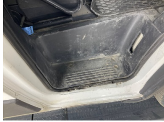
Kapı, sağ ön, Kapı fitili > Hasarlı
