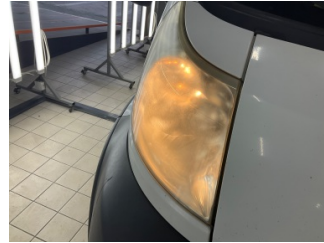
Farlar, Far camı, sağ > Deforme Olmuş
