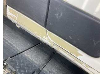
Marşbiyel, sağ, Marşbiyel, sağ > Boyası Atmış
