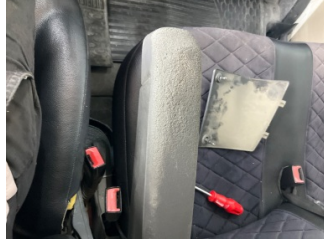
Döşemeler/Kapaklar, Kol dayaması, ön > Hasarlı
