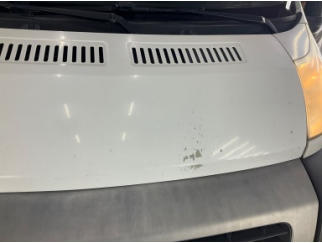
Motor kaputu, Motor kaputu > Boyası Atmış
