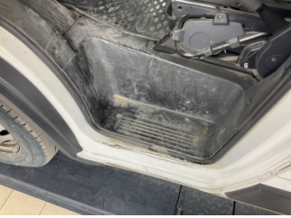
Kapı, sol ön, Kapı fitili > Hasarlı
