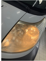
Farlar, Far camı, sol > Deforme Olmuş
