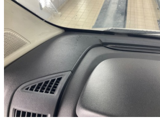
Döşemeler/Kapaklar, Döşemeler/Kapaklar > Deforme Olmuş
