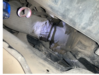
Motor, Turbo hortumları > Yağ Kaçağı
