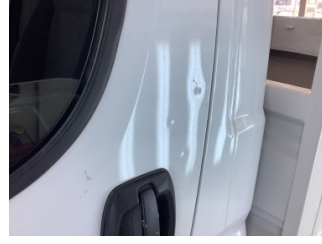
Kapı, sol ön, Kapı, sol ön > Ezik
