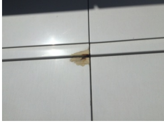
Bagaj kapağı/kapısı, Bagaj kapısı > Boyası Atmış
