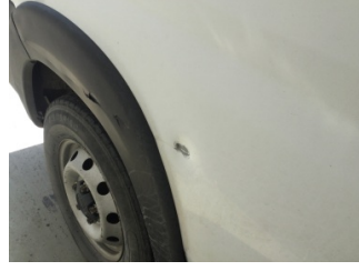
Çamurluk, sağ arka, Çamurluk, sağ arka > Ezik
