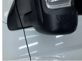
Dikiz aynası, sol, Dış dikiz aynası kapağı > Çizik
