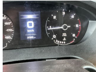
Elektrik donanımı/Pano, Gösterge panosu kapağı/camı > Çatlak
