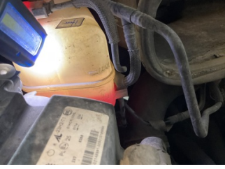
Motorsoğutması, Soğutma sıvısı > Eksik
