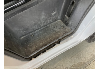
Kapı, sağ ön, Kapı fitili > Hasarlı
