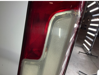
Arka lambalar, Arka lamba camı, sağ > Çatlak
