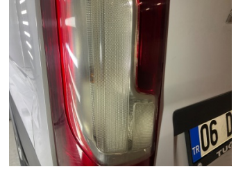
Arka lambalar, Arka lamba camı, sol > Çatlak
