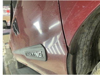
Kapı, sol arka, Kapı, sol arka > Hasarlı
