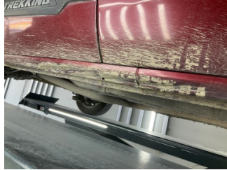
Marşbiyel, sağ, Marşbiyel, sağ > Hasarlı
