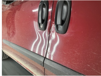
Kapı, sol arka, Kapı, sol arka > Hasarlı
