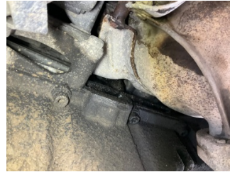
Motor, Motor > Yağ Kaçağı
