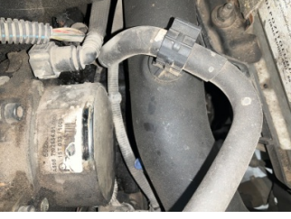
Motor, Motor > Yağ Kaçağı
