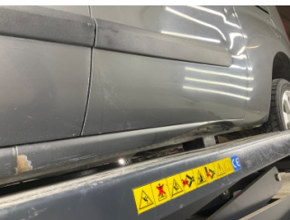
Marşbiyel, sol, Marşbiyel, sol > Hasarlı
