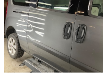
Kapı, sağ arka, Kapı, sağ arka > Ezik
