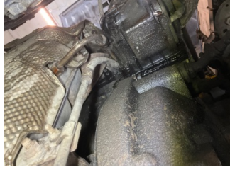
Motorsöğütması, Soğutma/Isıtma sistemi > Sızdırıyor
