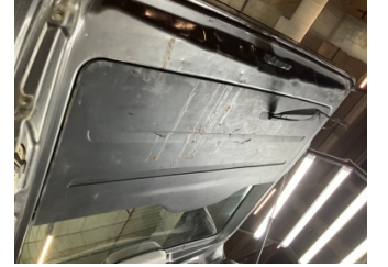
Döşemeler/Kapaklar, Döşemeler/Kapaklar > Çizik
