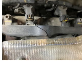
Motor, Enjektör kablo demeti > Hasarlı
