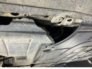
Motor, Alt muhafaza > Hasarlı
