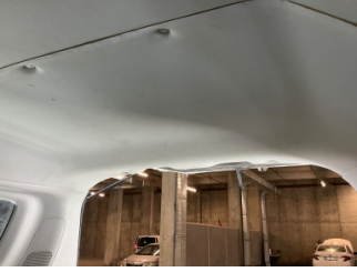
Döşemeler/Kapaklar, Tavan döşemesi > Deforme Olmuş
