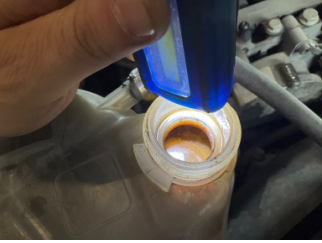
Motorsoğutması, Soğutma sıvısı > Kirlenmiş
