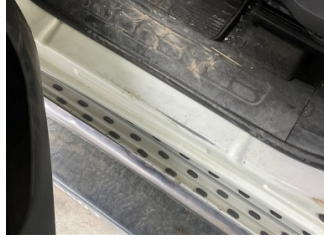
Marşbiyel, sol, Marşbiyel, sol > Boyası Atmış
