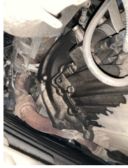
Şanzıman, Şanzıman > Yağ Kaçağı
