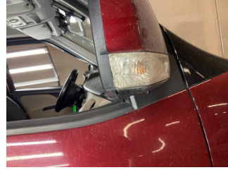
Dikiz aynası, sağ, Dış dikiz aynası çerçevesi > Hasarlı
