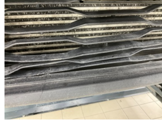
Tampon, ön, Ön tampon ızgarası > Kırılmış
