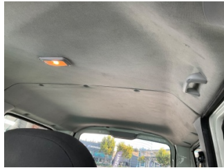
Döşemeler/Kapaklar, Tavan döşemesi > Deforme Olmuş
