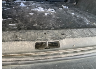
Döşemeler/Kapaklar, Yükleme eşiği kaplaması > Hasarlı
