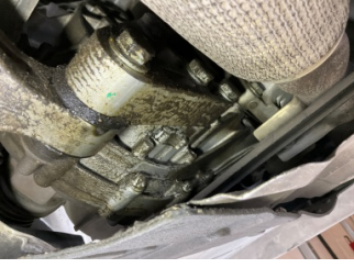
Şanzıman, Şanzıman > Yağ Kaçağı
