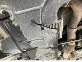
Motor, Alt muhafaza > Hasarlı
