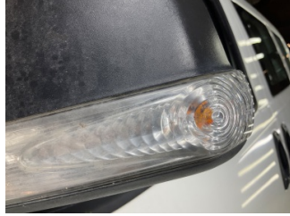
Dikiz aynası, sol, Sinyal lambası > Çatlak
