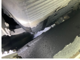
Motor, Motor > Yağ Kaçağı
