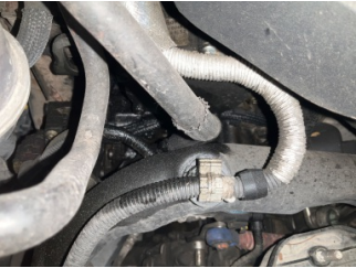
Motor, Yakıt sistemi > Sızdırıyor
