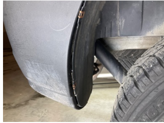
Çamurluk, sağ arka, Davlumbaz > Sabitlemesi Hatalı
