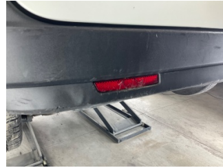
Tampon, arka, Reflektör, sol > Hasarlı
