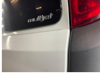
Bagaj kapağı/kapısı, Bagaj kapısı > Boyası Atmış
