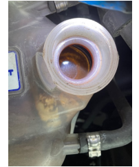
Motorsöğütması, Soğutma sıvısı > Kirlenmiş
