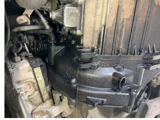
Motor, Motor > Yağ Kaçağı
