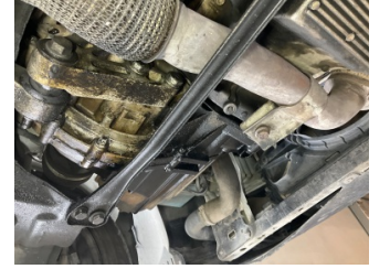
Motor, Motor > Yağ Kaçağı
