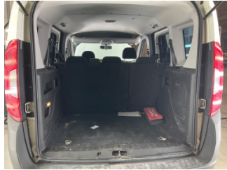
Döşemeler/Kapaklar, Pandizot > Sökülmüş-Yok
