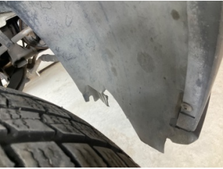
Çamurluk, sağ, Davlumbaz > Kırılmış
