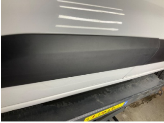
Kapı, sol ön, Kapı bandı > Çizik
