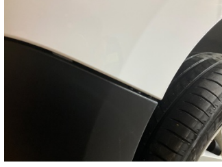
Tampon, ön, Ön tampon > Sabitlemesi Hatalı
