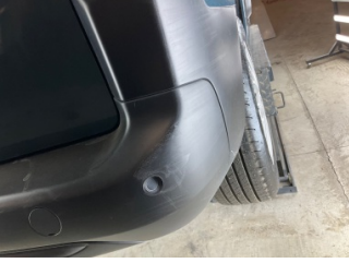
Tampon, arka, Arka tampon > Küçük Çizik
