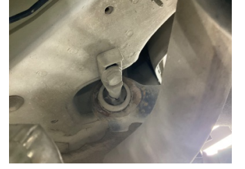
Arka aks, Porya taşıyıcısı, sağ > Deforme Olmuş
