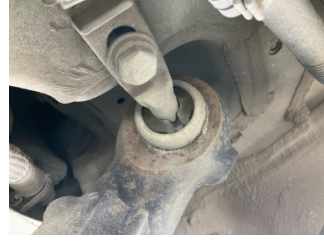
Arka aks, Porya taşıyıcısı, sol > Deforme Olmuş
