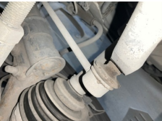
Ön aks, Denge çubuğu, bağlantı cubuğu sol > Hasarlı
