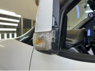
Dikiz aynası, sol, Sinyal lambası > Çatlak
