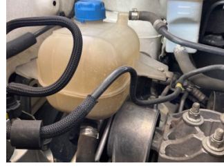
Motorsoğutması, Soğutma sıvısı > Eksik
