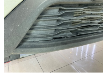
Tampon, ön, Ön tampon ızgarası > Hasarlı
