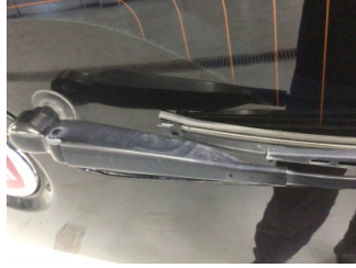
Cam yıkama/silme sistemi, Silecekler, arka > Deforme Olmuş
