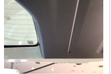
Döşemeler/Kapaklar, Bagaj kapağı, iç döşemesi > Çizik
