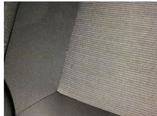
Koltuklar, ön, Koltuk döşemesi, sağ ön > Yakıcı Madde Ile Zarar Görmüş
