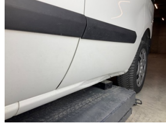
Marşbiyel, sol, Marşbiyel, sol > Hasarlı
