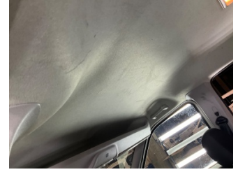
Döşemeler/Kapaklar, Döşemeler/Kapaklar > Deforme Olmuş
