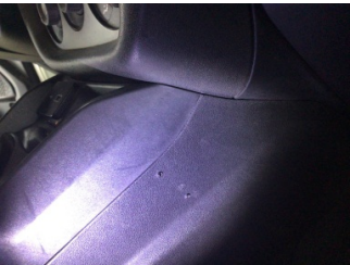
Döşemeler/Kapaklar, Orta konsol, ön > Delinmiş
