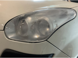
Farlar, Far camı, sol > Deforme Olmuş
