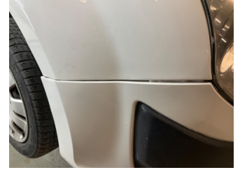
Tampon, ön, Ön tampon > Sabitlemesi Hatalı
