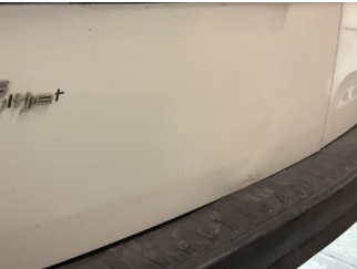
Bagaj kapağı/kapısı, Bagaj kapısı > Ezik
