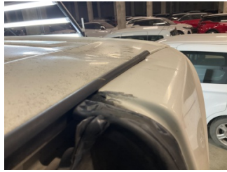
Bagaj kapağı/kapısı, Bagaj kapısı > Ezik
