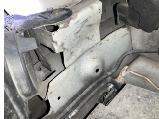
Kaporta, Sağ Kılıç Sacı > Hasarlı
