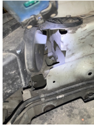
Kaporta, Sağ Kılıç Sacı > Hasarlı
