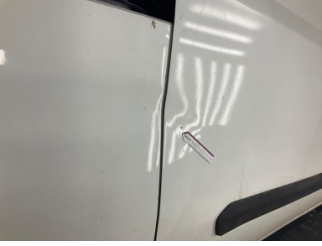
Kapı, sağ arka, Kapı, sağ arka > Ezik
