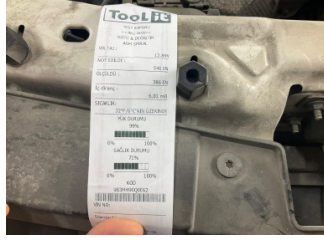
Elektrik donanımı/Pano, Akü > Test Sonucu
