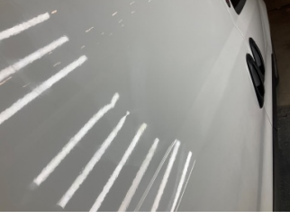
Kapı, sağ arka, Kapı, sağ arka > Ezik
