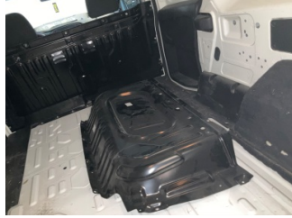
Döşemeler/Kapaklar, Bagaj kapağı, iç döşemesi > Sabitlemesi Hatalı
