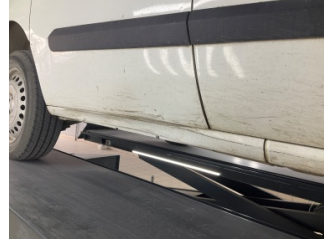
Marşbiyel, sağ, Marşbiyel, sağ > Hasarlı
