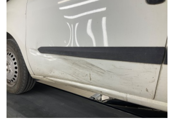
Kapı, sol ön, Kapı, sol ön > Hasarlı
