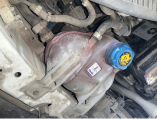
Motorsoğutması, Soğutma sıvısı > Sızdırıyor
