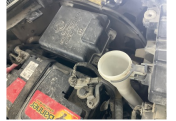
Cam yıkama/silme sistemi, Cam suyu bidonu kapağı > Sökülmüş-Yok
