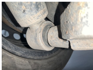
Arka aks, Amortisör, arka > Deforme Olmuş
