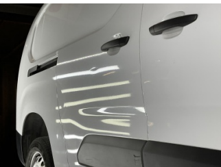
Kapı, sağ arka, Kapı, sağ arka > Ezik
