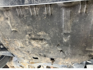
Motor, Alt muhafaza > Hasarlı
