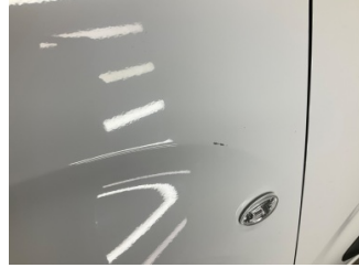
Çamurluk, sol, Çamurluk, sol > Boyası Atmış
