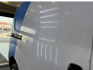
Kapı, sağ arka, Kapı, sağ arka > Ezik
