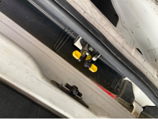
Bagaj kapağı/kapısı, Menteşe > Sökülmüş-Yok
