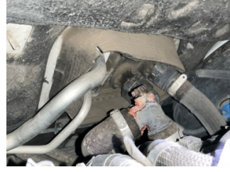
Motorsoğutması, Soğutma sıvısı > Sızdırıyor
