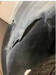
Çamurluk, sol, Davlumbaz > Hasarlı
