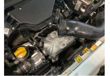
Motor, Hava filtresi > Sabitlemesi Hatalı
