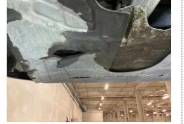
Motor, Alt muhafaza > Hasarlı
