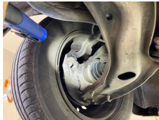
Direksiyon sistemi, Rot kolu/Rot başı, sol > Hasarlı
