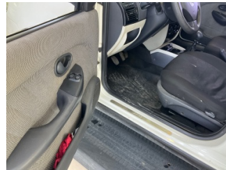
Döşemeler/Kapaklar, Döşemeler/Kapaklar > Deforme Olmuş
