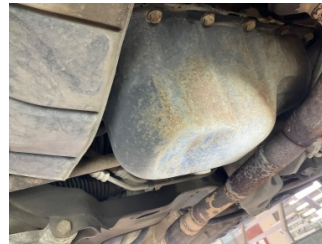
Motor, Yağ karteri > Hasarlı
