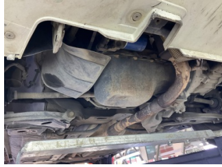
Motor, Alt muhafaza > Sökülmüş-Yok
