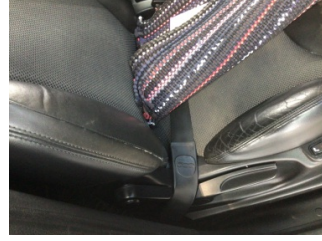
Koltuklar, ön, Koltuk, sağ ön > Deforme Olmuş
