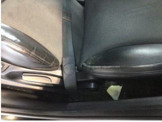
Koltuklar, ön, Koltuk, sol ön > Deforme Olmuş
