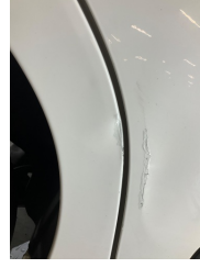
Çamurluk, sağ arka, Çamurluk, sağ arka > Ezik
