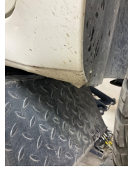
Marşbiyel, sağ, Marşbiyel, sağ > Hasarlı
