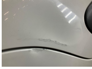
Kapı, sağ arka, Kapı, sağ arka > Ezik
