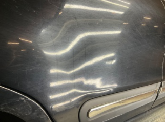
Kapı, sağ arka, Kapı, sağ arka > Ezik
