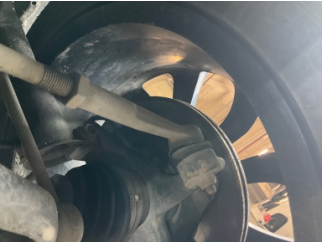
Ön aks, Denge çubuğu, ön > Hasarlı
