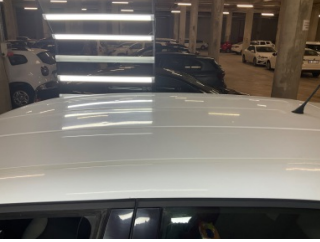
Tavan, Tavan > Dolu Hasarı
