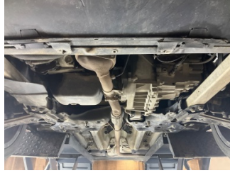
Motor, Alt muhafaza > Sökülmüş-Yok
