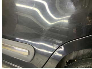
Kapı, sol arka, Kapı, sol arka > Çizik
