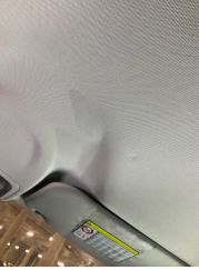
Döşemeler/Kapaklar, Tavan döşemesi > Deforme Olmuş
