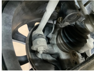
Ön aks, Denge çubuğu, ön > Hasarlı
