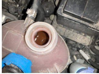
Motorsoğutması, Soğutma sıvısı > Kirlenmiş
