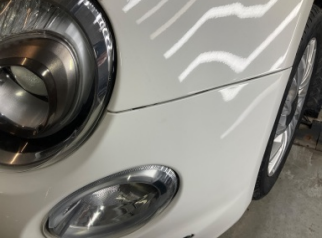
Tampon, ön, Ön tampon > Sabitlemesi Hatalı
