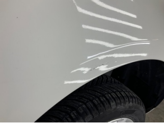
Çamurluk, sol arka, Çamurluk, sol arka > Boyası Atmış
