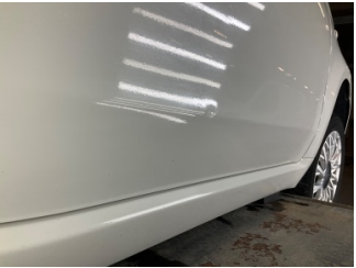
Kapı, sağ ön, Kapı, sağ ön > Vuruk
