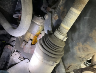
Motor, Motor > Yağ Kaçağı
