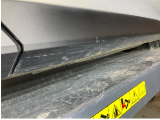
Kapı, sağ ön, Kapı bandı > Çizik
