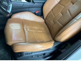
Döşemeler/Kapaklar, Döşemeler/Kapaklar > Deforme Olmuş
