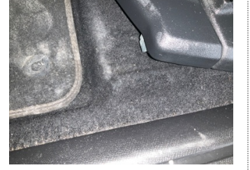
Döşemeler/Kapaklar, Döşemeler/Kapaklar > Yakıcı Madde Ile Zarar Görmüş
