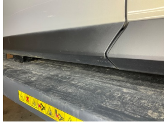
Kapı, sol ön, Kapı bandı > Çizik
