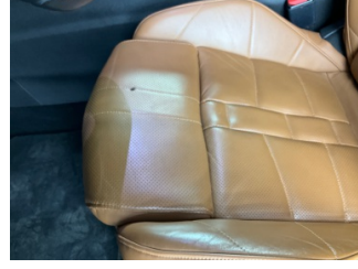
Döşemeler/Kapaklar, Döşemeler/Kapaklar > Yakıcı Madde Ile Zarar Görmüş
