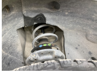
Ön aks, Amortisör körüğü, sağ > Hasarlı
