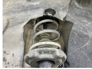
Ön aks, Amortisör körüğü, sol > Hasarlı
