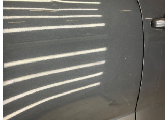
Kapı, sağ arka, Kapı, sağ arka > Ezik
