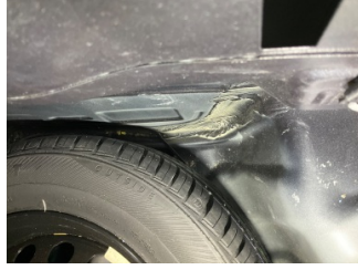
Arka bölüm, Bagaj havuzu > Hasarlı
