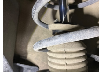
Ön aks, Amortisör körüğü, sağ > Hasarlı
