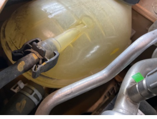
Motorsoğutması, Soğutma sıvısı > Eksik
