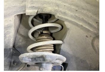
Ön aks, Amortisör körüğü, sağ > Hasarlı
