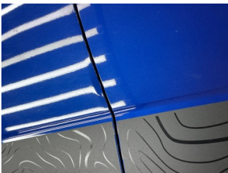
Kapı, sol ön, Kapı, sol ön > Ezik
