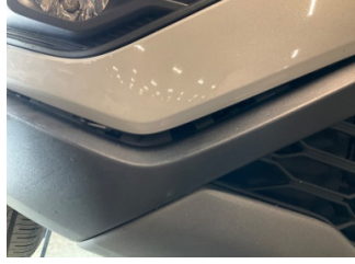
Tampon, ön, Spoiler > Sabitlemesi Hatalı
