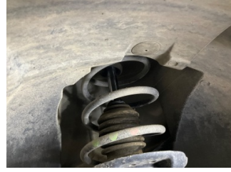
Ön aks, Amortisör körüğü, sol > Hasarlı
