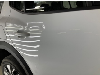
Kapı, sağ arka, Kapı, sağ arka > Ezik
